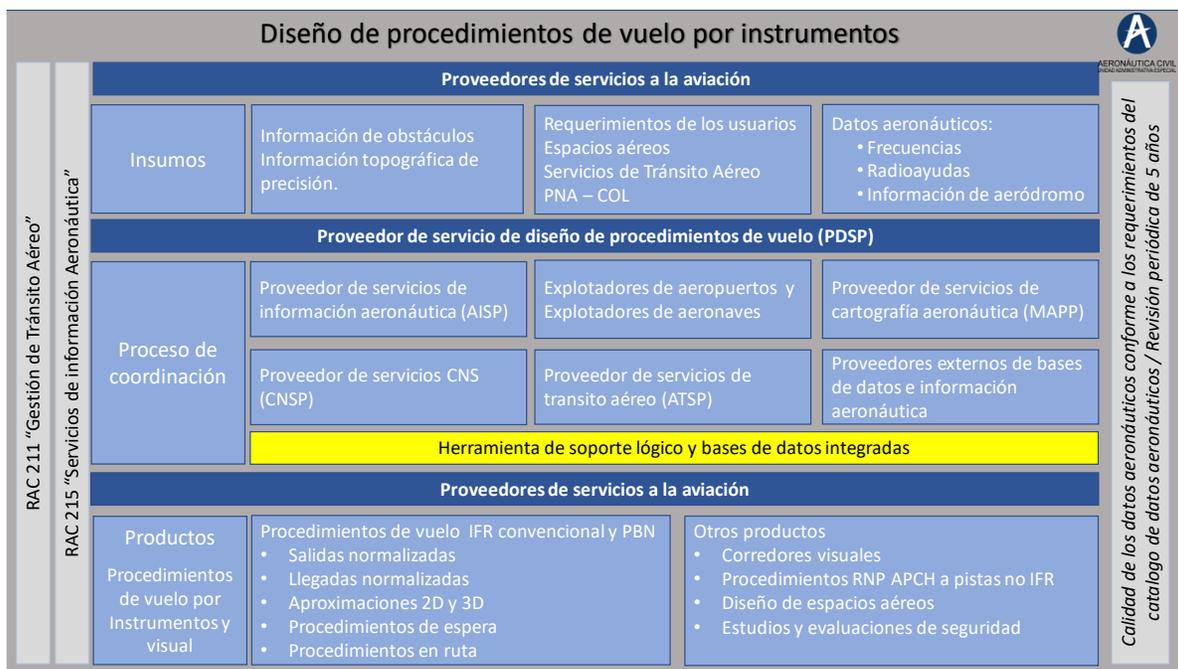
Diagrama Descripción del servicio de diseño de procedimientos de vuelo por instrumentos y visual. Fuente: Autoridad
